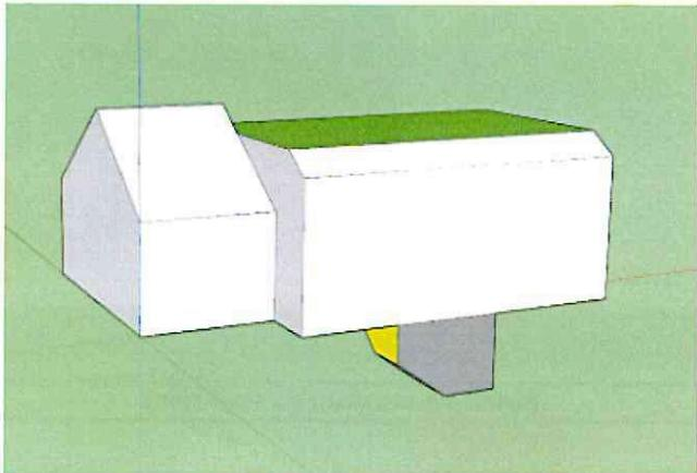
Le volume protégé d'un logement reprend tous les espaces du logement que l'on souhaite protéger des déperditions thermiques que ce soit vers l'extérieur, vers le sol ou encore des espaces non chauffés (cave, annexe, bâtiment mitoyen...). Il comprend au moins tous les locaux chauffés. Lorsqu'une paroi dispose d'un isolant thermique, elle délimite souvent le volume protégé.
