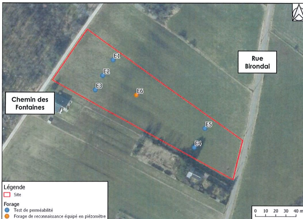
Figure 1 : implantation des forages et tests
